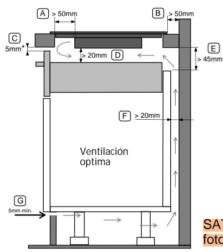
¡ATENCIÓN! Una instalación inadecuada y no respetar las ventilaciones puede provocar mal funcionamiento o avería en el aparato que no estarían cubiertos por la garantía del fabricante.
